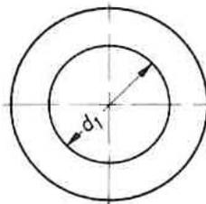
Bezeichnung einer Scheibe (A) von Lochdurchmesser  $d_1 = 18$  mm aus Stahl (St):
